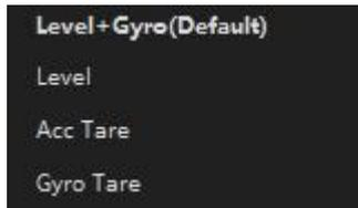
**Level:** 坐标系转换功能按钮。将模块安装平面**水平放置**时(通过全站仪或者气泡居中方法), 此时输出的俯仰角和横滚角一般不为零, 说明模块与安装平面存在安装误差角。将模块静止放置, 点击该按钮后上位机将自动计算出该安装误差角的大小, 通过模块内置的旋转矩阵算法将模块坐标系转换到安装平面坐标系。该功能一般用于 **RTK** 倾斜测量领域, 点击完该按钮后需要点击 **Write Flash** 按钮进行参数保存。
